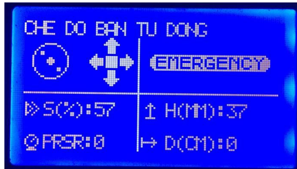
Hình 20. Màn hình hiển thị cảnh báo tắt khẩn cấp
